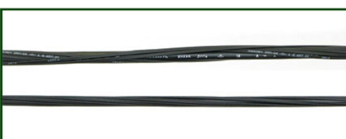
Жгут из тонких оптических кабелей навитых на ОКСН (сверху) и трос (снизу)
